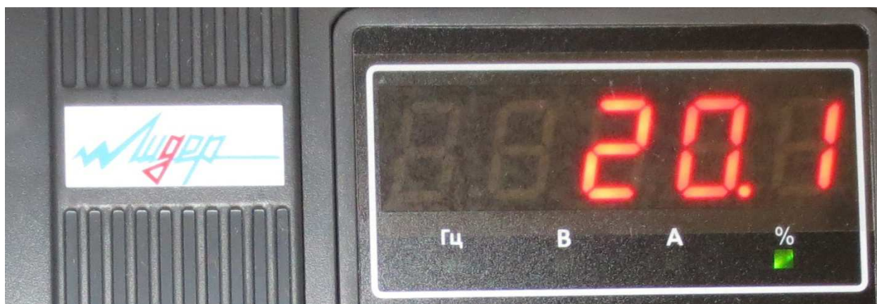
Рис. 5 Параметр обратной связи ПИД
